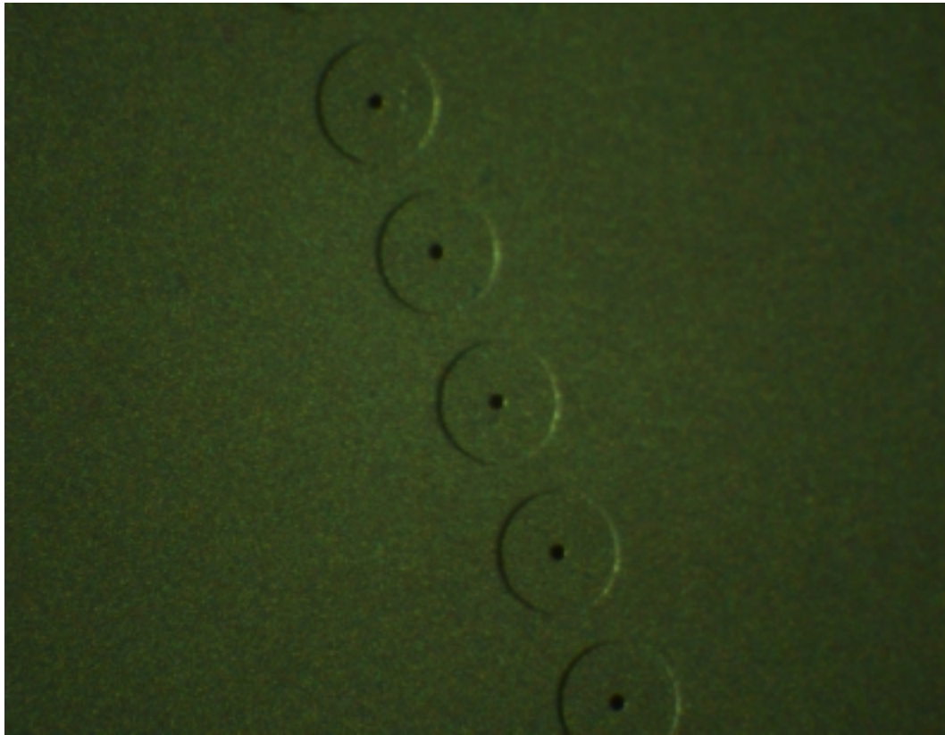
Abbildung 6 : Druckkopf für Epson-Tinte verwendet (5 Düsenöffnungen der Epson-Tinte)
