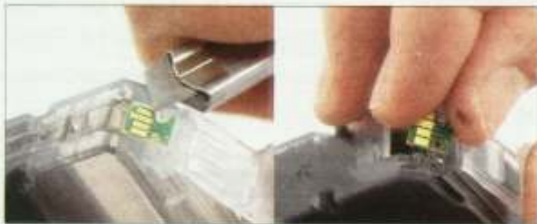
Vergangenheit: Der knifflige Chip-Umbau von den Originalpatrone (links) auf die Fremdpatrone (rechts) ist mit den jetzt getesteten Produkten nicht mehr nötig. Sie haben einen eigenen Chip.
