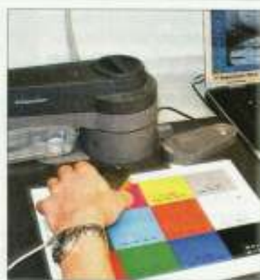
Mit dem Gretag-Macbeth-Densitometer überprüfen die Tester die Qualität der Farbwiedergabe.
